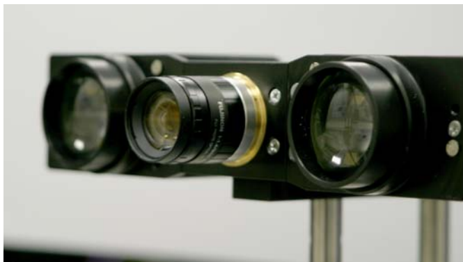
Bild 12 3D-Kamera mit 1024 (64x16) PMD-Pixeln
