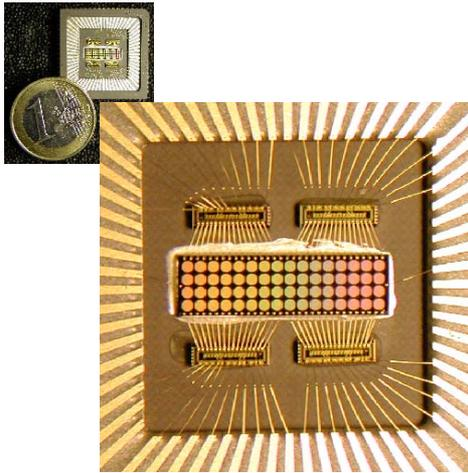
Fig.4. 16x4 PMD-array respectively a 32 OEP-array
