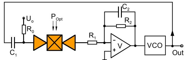
Fig. 2. PLL / DLL using MSM-PMD or MSM-OEP
