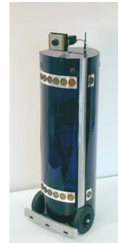
Roboter MOSRO** mit 3D-PMD-Videokamera
